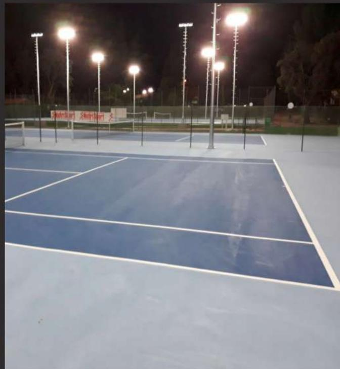
\*Résultats avec 4 mâts d'éclairage par terrain de 9 m de hauteur.
